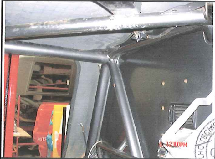
FOTO Junção arco principal com estrutura superior
