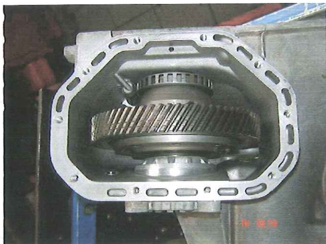
FOTO N° 03 – Blocante montado
