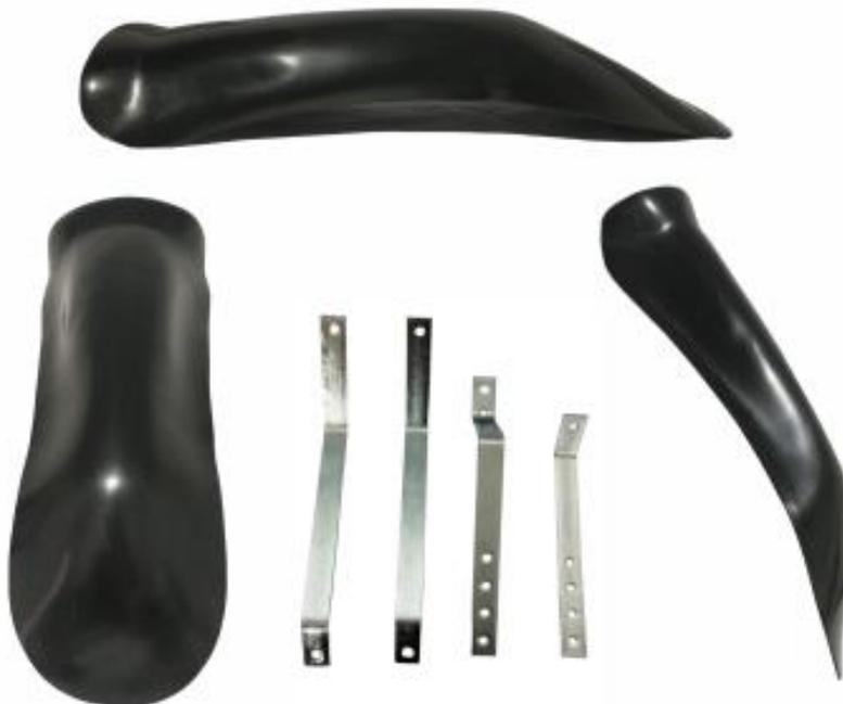
FOTO FRONTAL, SUPERIOR E LATERAL DO PAINEL SUPERIOR DIANTEIRO (GRAVATA) COM SUPORTES E FIXAÇÕES.
