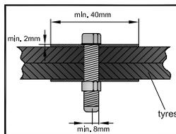
Bande transporteuse dont l'angle d'impact probable est inférieur à 45°. Note : dans le cas d'autres connexions / raccorde-ments, la décision doit être prise par l'inspecteur.
