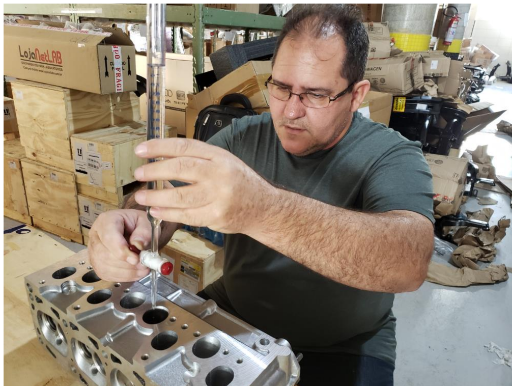
Imagem 9 – aferição de volume com auxílio de bureta graduada
