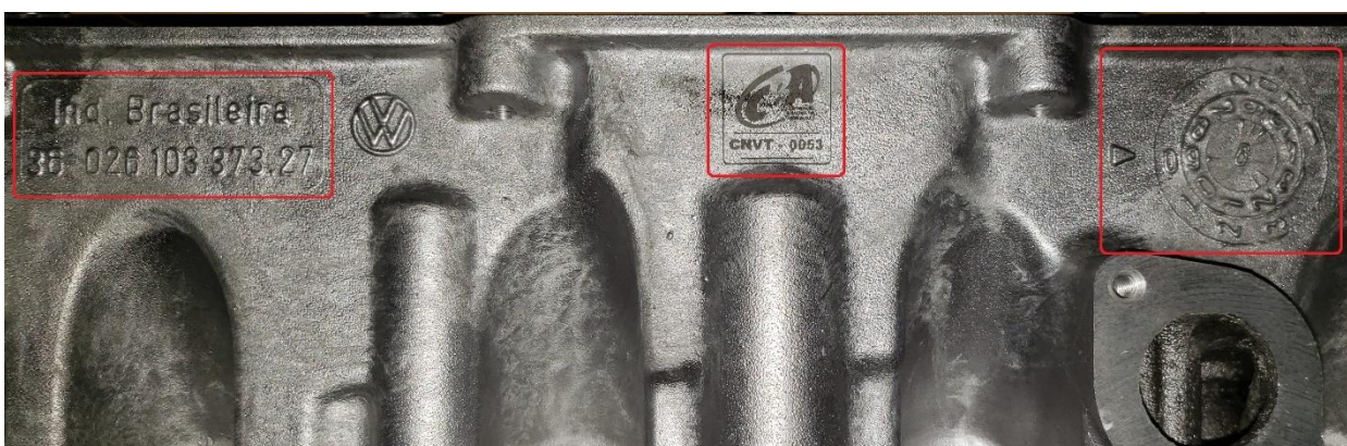
Imagem 15 – indicação dos pontos de identificação do cabeçote
