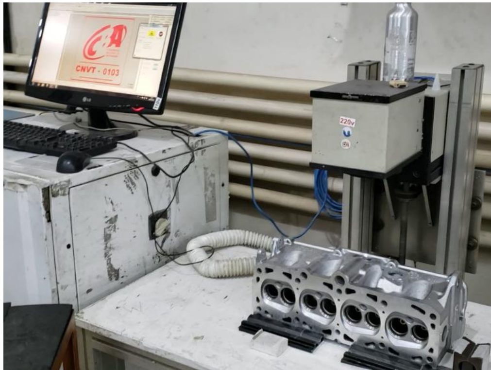
Imagem 12 – cabeçote em processo de gravação do lacre CBA à laser
