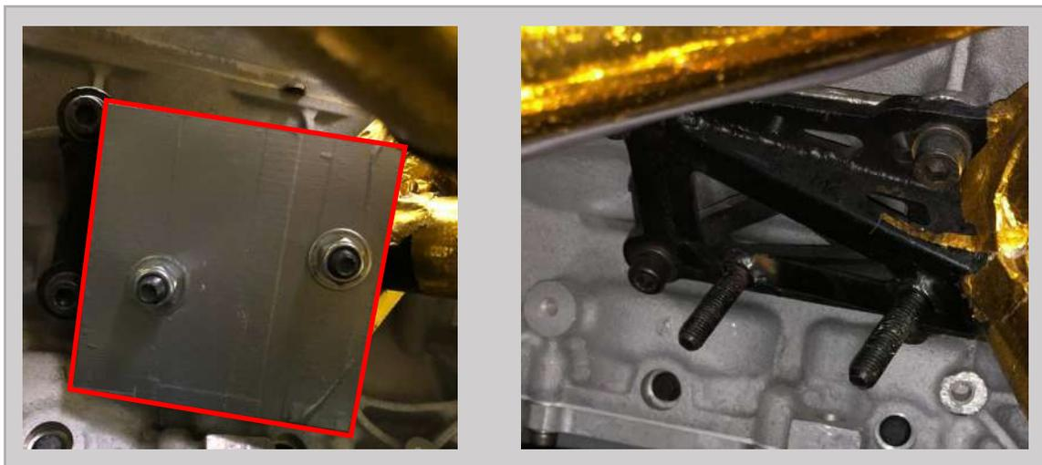
Quando necessário o lastro de compensação, o mesmo deverá estar dividido por em duas partes iguais, uma em cada coordenada especificada.
