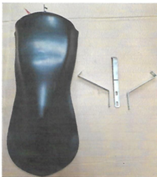
FOTO FRONTAL, SUPERIOR E LATERAL DO PAINEL SUPERIOR DIANTEIRO (GRAVATA) COM SUPORTES E FIXAÇÕES.
