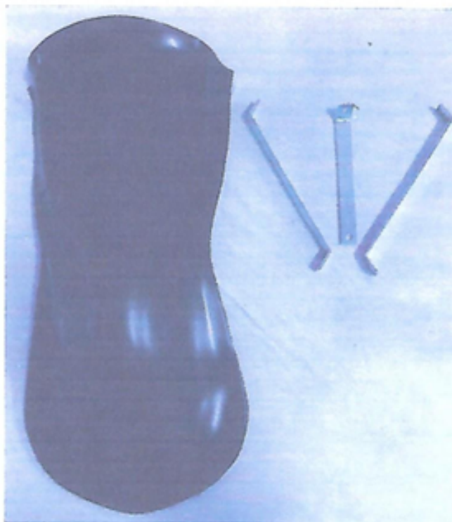
FOTO FRONTAL, SUPERIOR E LATERAL DO PAINEL SUPERIOR DIANTEIRO (GRAVATA) COM SUPORTES E FIXAÇÕES.
