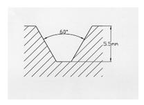
**2.5** En el área de control, la superficie ocupada por surcos de al menos 1.8mm de profundidad, con un ángulo máximo de 60entre los bloques en sección (diagrama) y 2mm de ancho, tiene que ocupar al menos el 21.5% de la superficie total.
