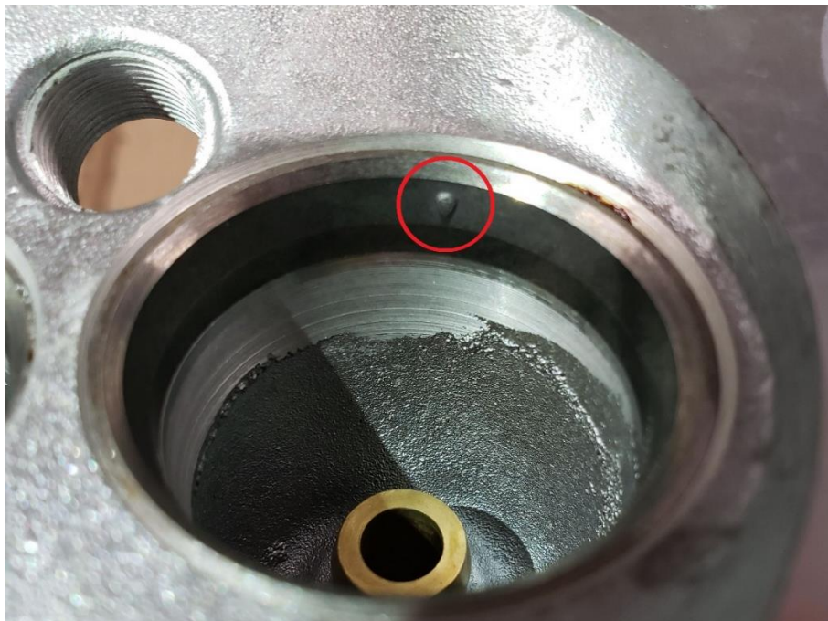
Imagem 4 – Identificação da marca original do fabricante no ângulo de correção inferior da sede.
