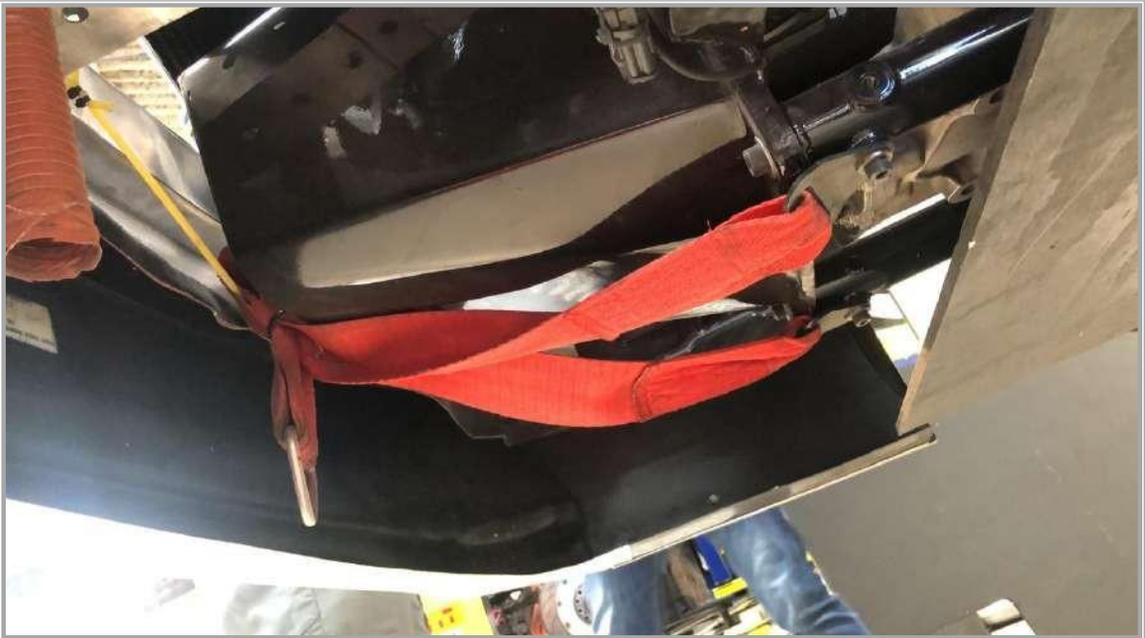
**Possibilidade #2** - Desta forma a cinta será fixado na parte superior do crash box (parafusos), um pequeno guia de alumínio deverá ser soldado no para-choque metálico. Necessário costurar uma cinta fina na ponta da cinta principal.
