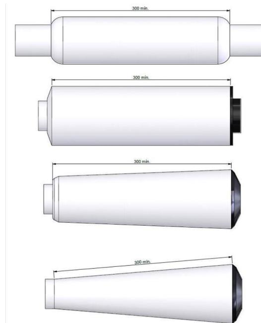
Imagem 8- Método de medição do abafador.
