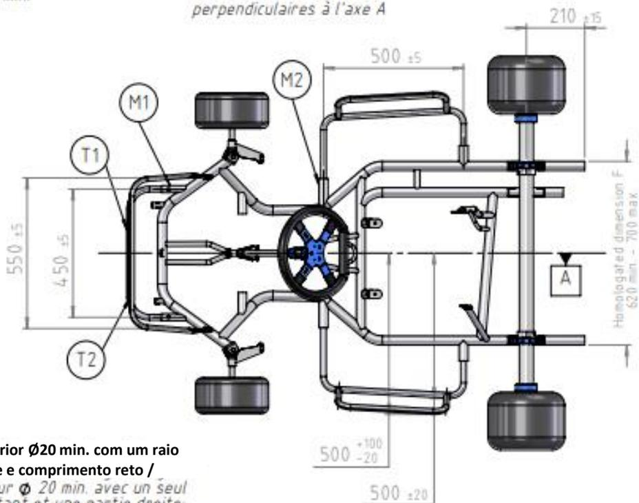
**T1: Tubo inferior Ø20 min. com um raio**
