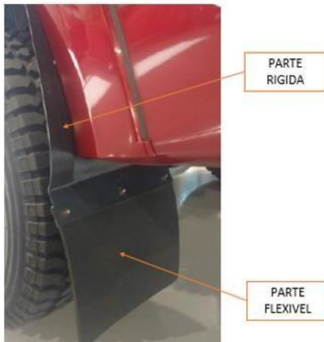
11.4.1 É permitida a alteração do material flexível do para-barro. A largura deve ultrapassar a largura do pneu em no mínimo 2mm de cada lado, e comprimento mínimo de 230mm.
