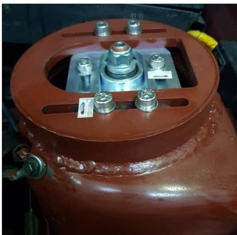
camber/caster plates, sem a extração total da lata original, conforme foto abaixo:
