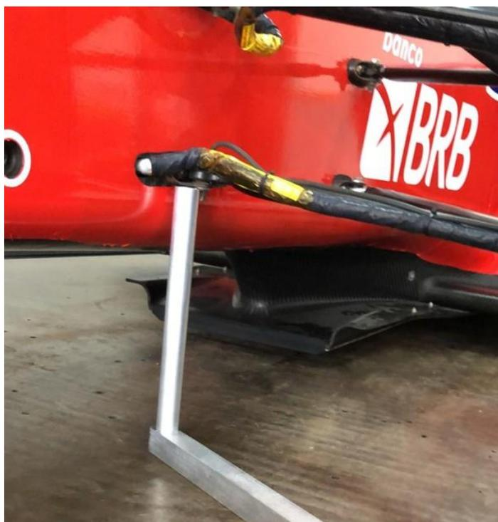
Altura mínima será verificada através do gabarito físico como demonstrado na imagem acima. A altura será definido pela distância do piso de referência e a face inferior do pick up do triângulo dianteiro inferior (perna dianteira) de ambos os lados.
