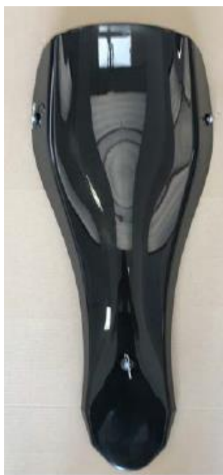
FOTO FRONTAL, SUPERIOR E LATERAL DO PAINEL SUPERIOR DIANTEIRO (GRAVATA) COM SUPORTES E FIXAÇÕES.
