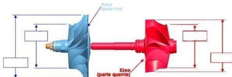
Obs: Essa progressão de medidas dos rotores (inducer e exducer, conforme foto acima) deve ser feita de forma linear. Cujo o tamanho máximo do diâmetro interno da carcaça fria (Compressor cover inducer) onde o rotor tem a medida máxima de 60,2mm, deverá ser de no máximo 61,7mm.
