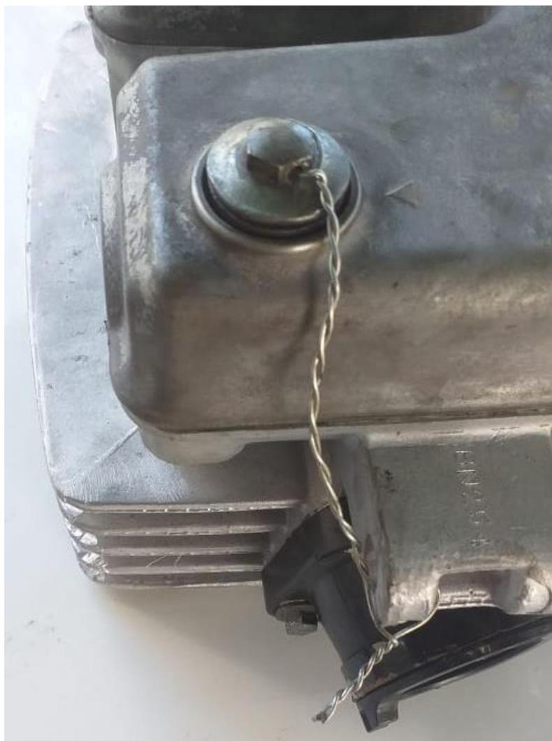
Imagem 3 – Detalhe furo passante no parafuso do cabeçote
