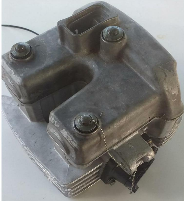
Imagem 2 – Detalhe furo passante no parafuso do cabeçote
