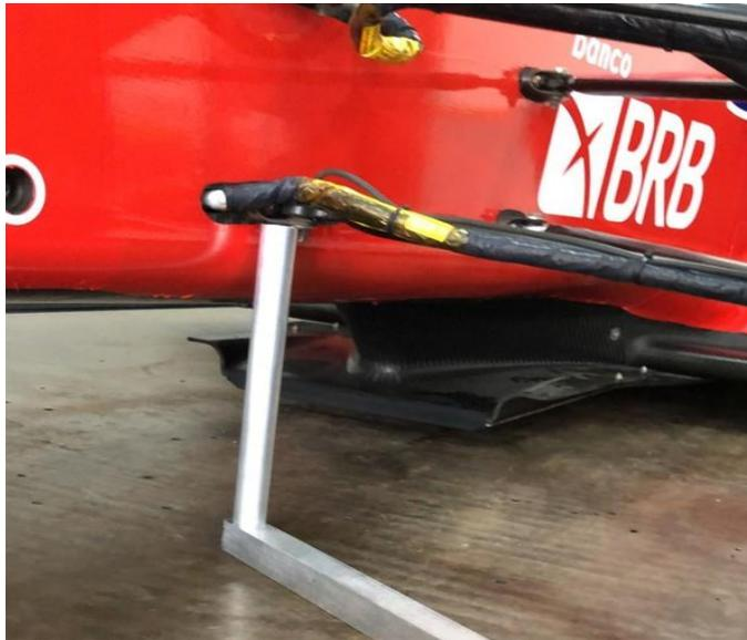
Altura mínima será verificada através do gabarito físico como demonstrado na imagem acima. A altura será definido pela distância do piso de referência e a face inferior do pick up do triângulo dianteiro inferior (perna dianteira) de ambos os lados, em condições de chuva a medição deverá ser feita com pneus slick.
