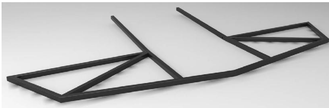
Estrutura do Assoalho Dianteiro – imagem desenho sugerido
