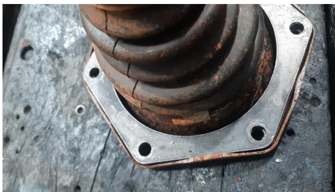
Imagem 15 – chapa de reforço da flange da capa do semieixo.
