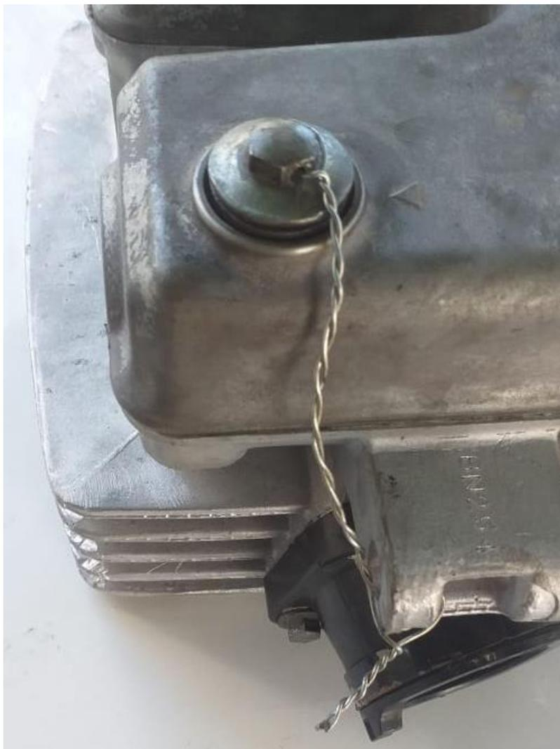
Imagem 2 – Detalhe furo passante no parafuso do cabeçote
