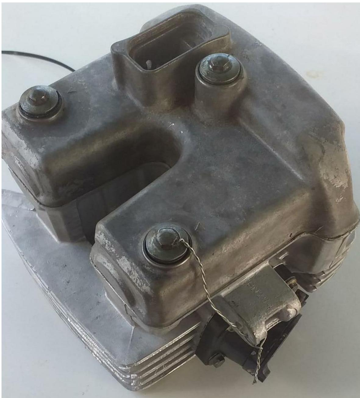
Imagem 1 – Detalhe furo passante no parafuso do cabeçote
