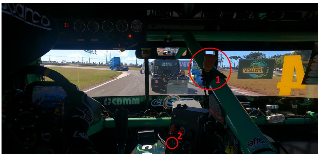
(1) Chave de Corte Geral (Kill Switch) dentro da cabine; (2) Chave de habilitação do sistema híbrido elétrico dentro da cabine.
