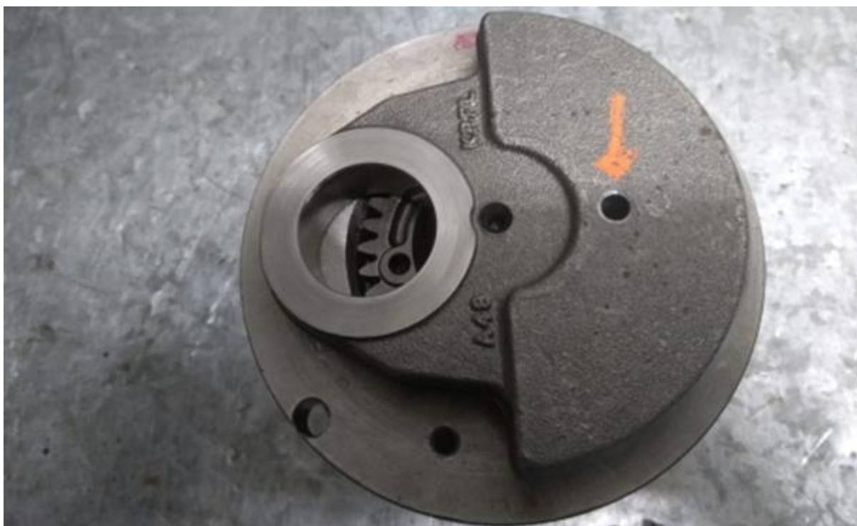
Imagem 5 - detalhe do furo na bolacha do virabrequim
