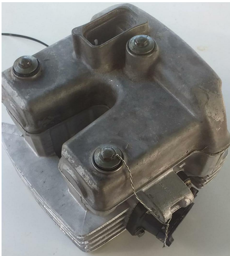
Imagem 2 – Detalhe furo passante no parafuso do cabeçote
