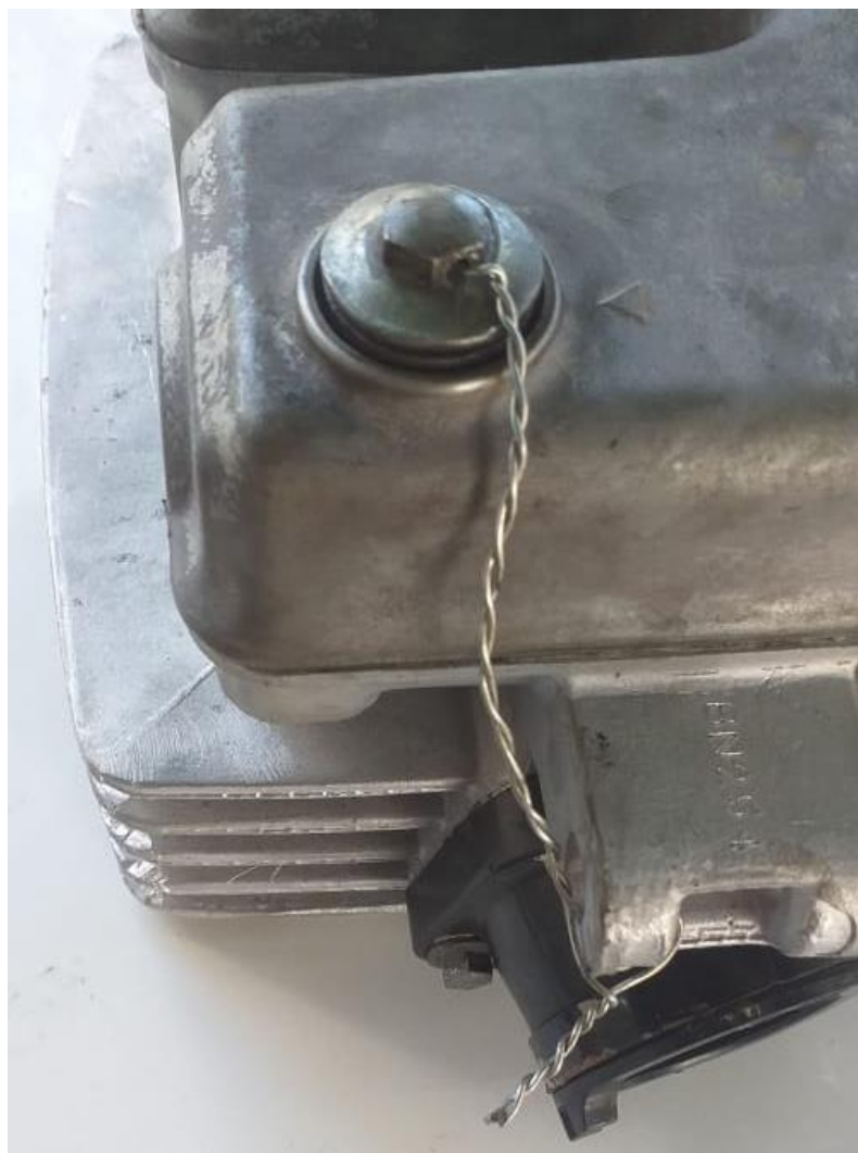
Imagem 3 – Detalhe furo passante no parafuso do cabeçote
